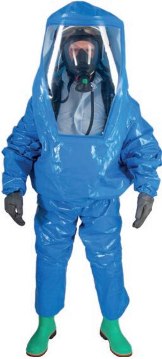
El traje GLS 300A en Chemprotex™ 300 es un traje de protección química hermético a los gases totalmente hermético y de un solo uso, que cubre tanto al usuario como al aparato de respiración. El traje combina los beneficios de una tela de barrera química ligera de alto rendimiento con una construcción hermética al gas según método 2 de ISO 17491-1. Incorpora guantes químicos antiestáticos, calcetines y un cierre ligero hermético a gas.
